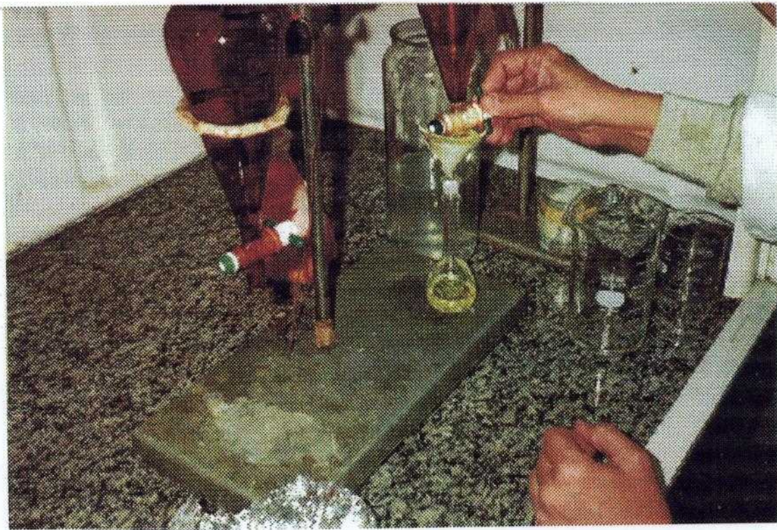
Figura 6 - Extração da vitamina A com éter de petróleo
