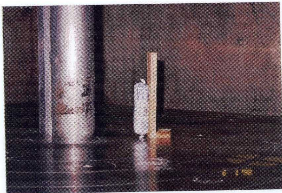
Figura 3 – Amostra de patê de fígado suíno na fonte panorâmica de ^{60}\text{Co}
